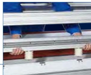
Schnellentnahme des Segmentmoduls
