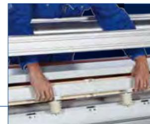
Einbau eines Keramikmoduls
