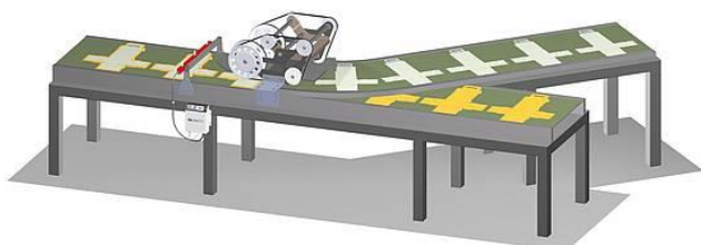
Využití statické elektřiny u knihařských strojů přesně zafixuje polohu a zabrání pohybu např. jednotlivých archů.
