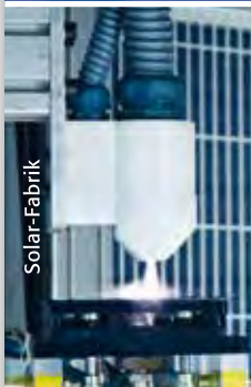
Stationärer Sprühkopf mit robotergeführten Formteilen
