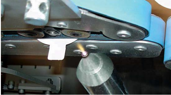
Aktivácia povrchu plastových uzáverov pred tlačou
