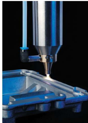
AntiCorr ® Plasma coating – vytváranie antikoróznej vrstvy na povrchu Al
