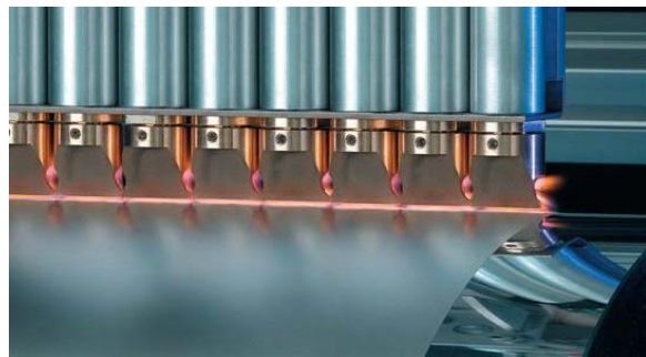
AntiCorr ® Plasma coating – vytváranie antikoróznej vrstvy na povrchu Al
