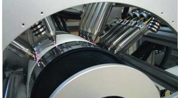
Čistenie povrchu hliníkovej fólie pri vysokej rýchlosti
