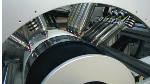
Čištění povrchu hliníkové fólie při vysoké rychlosti
