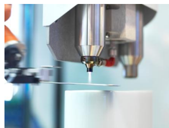
Plasma SealTight® - povlak pro zvýšení adheze při spojení kovu a plastu při vstřikování
